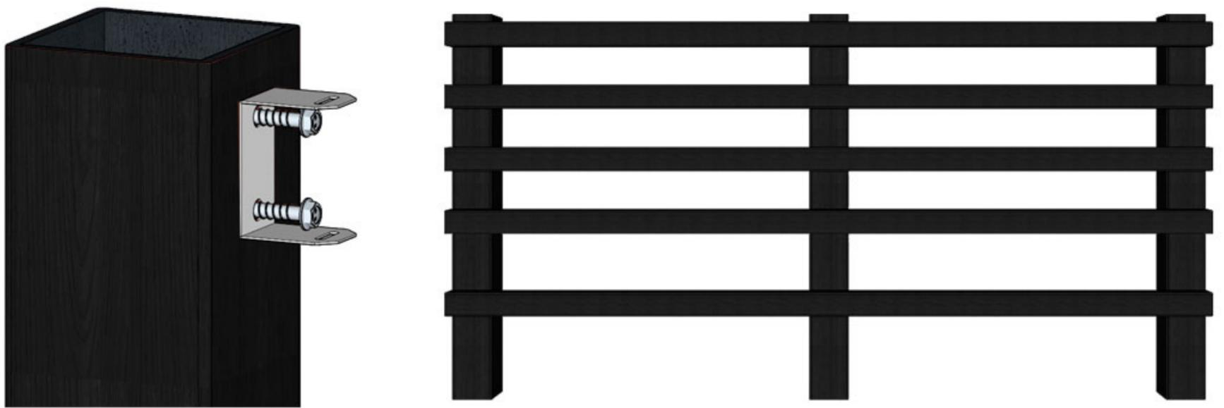
4 - Para a fixação do perfil 120x120mm, deve-se colocá-lo no encaixe metálico, com parafuso francês passante anterior à cruzeta, e utilizando a porca sextavada para travamento.
