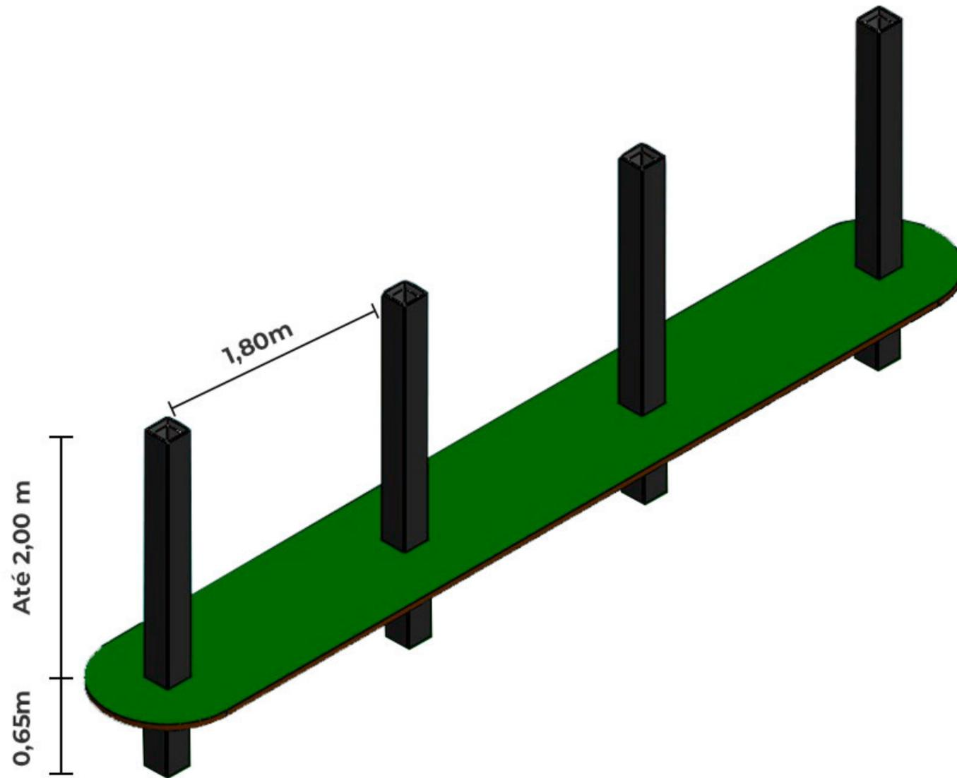
2 - Utilize a armação metálica indicada no desenho pelo interior da coluna, concretando o espaço interno da peça.
