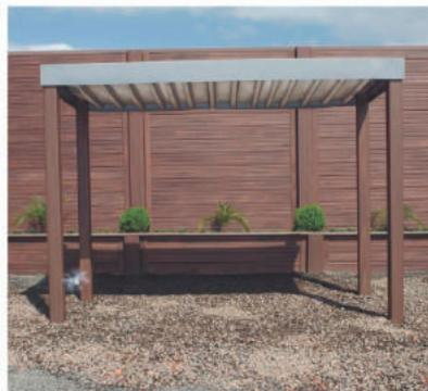
Ponto de ônibus ecológico em madeira plástica, fabricado através de polímeros reciclados. A estrutura é composta por: Telhado rotomoldado; Barra chata 2" x 3/16" -2 unidades de 3,00m; Barra chata 2" x 3/16" -4 unidades de 1,20m; perfil de madeira plástica 120x120mm com metalon cor ipê - 4 peças de 2,70m. Observação: Descrição básica do produto que, segundo especificações, pode atender critérios de similaridade ou equivalência.
